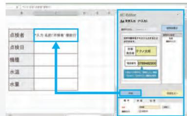
右側のパネルでは、各種機能・設定ごとに説明画像が表示されます。画像を確認して、項目の名前や入力機能の詳細設定を行います。作成ボタンを押すと、セルに機能が設定されます。
