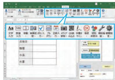
入力機能を設定するセルを選択し、XC-Editorのタブの機能一覧から設定したい入力機能のアイコンをクリックします。
