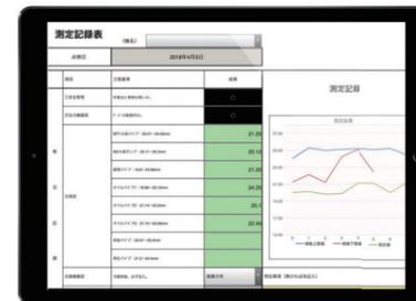
工具測定機器に計測器Bluetoothアダプタを取り付けることで、計測器から測定値を自動入力できます。入力ミスや転記作業をなくし、作業効率とデータの正確性がアップするため、加工記録や品質チェックの業務などで利用されています。
